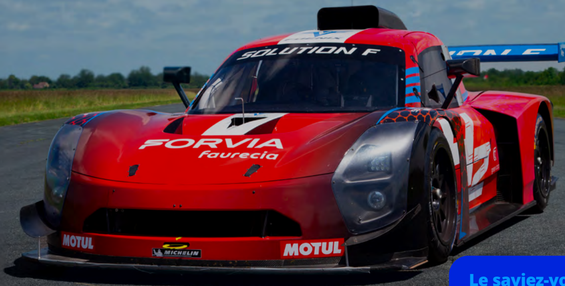
La Foenix H2. Une voiture de course à moteur thermique à hydrogène équipée de réservoirs d'hydrogène gazeux XL de FORVIA.
