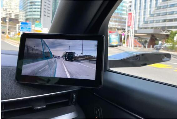
La plateforme logicielle eMirror Safe UX optimise la technologie eMirror de FORVIA pour améliorer la visibilité des conducteurs. En remplaçant les rétroviseurs conventionnels par un système de caméras, eMirror Safe UX offre une meilleure vision, des alertes de sécurité, ainsi que des économies de carburant et d'énergie. Le logiciel élargit le champ de vision, diminue les angles morts avec des fonctionnalités telles que
