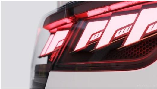
Le FlatLight |  $\mu$ MX de HELLA est une technologie innovante qui utilise un guide de lumière à LED novateur avec des micro-optiques. Ces optiques sont plus petites qu'un grain de sel, rendant FlatLight |  $\mu$ MX particulièrement plat, efficace et adaptable, avec une espace nécessaire pour l'installation de seulement 5 mm, soit une réduction de jusqu'à 90 %. Un seul élément optique peut
