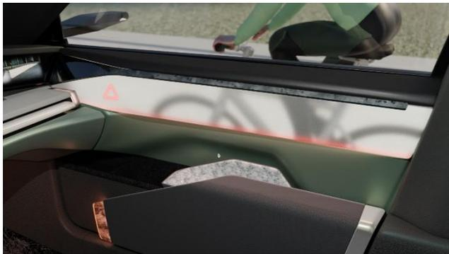
Le Light Tile for Transparent Door de FORVIA est un dispositif qui permet de transformer les panneaux de porte en agrandissant virtuellement des fenêtres. En cas de risque détecté avant l'ouverture de la portière, il affiche des informations afin d'aider les occupants à réagir plus vite dans l'obscurité ou des conditions
