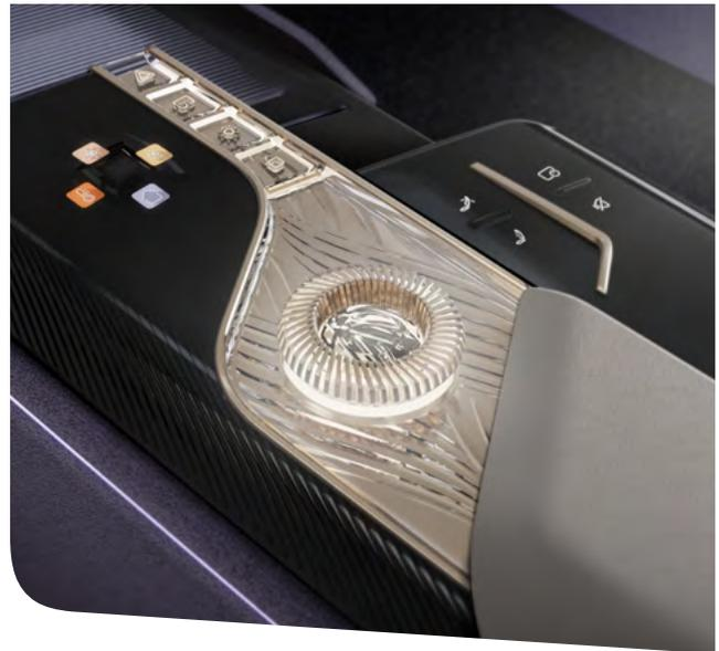
Le **confort thermique**, à travers un vaste éclairage de surface et un chauffage par panneaux radiants injectés. Une solution efficace qui consomme 30 % de kilowattheures en moins, ce qui favorise l'autonomie des véhicules électriques.
